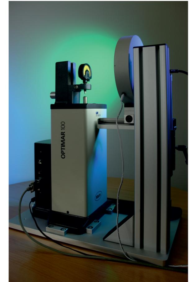
**QMSOFT®** unterstützt neben allen konventionellen auch modernste Kalibriertechnologien wie optische und mechanische Scan-Verfahren (z.B. zur Kalibrierung von zylindrischen bzw. kegeligen Gewindelehren) oder die Bildverarbeitung für die automatisierte Prüfung von analogen und digitalen Messuhren.
